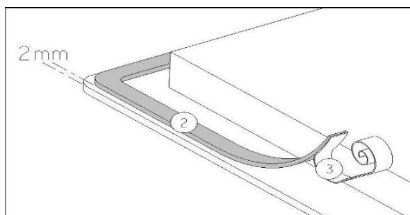
Pegar la junta (2) sobre el reborde de la placa, a 2 mm del borde exterior, después de haber quitado la lámina de protección (3).
