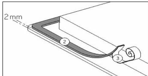
Należy zdjąć z uszczelki taśmę ochronną (3), a następnie przykleić uszczelkę (2) dwa mm od zewnętrznej krawędzi szkła.
