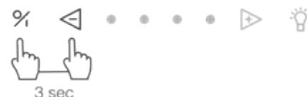
Funkci lze zapnout současným přidržením tlačítek a po dobu 3 sekund. 2. a 4. LED kontrolka 3krát zabliká pro potvrzení (spotřebič musí být vypnutý).
