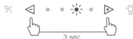
Doba zpozdění se opět nastaví na 10 minut ( místo 30 minut) a indikátor čištění pro recirkulaci se vypne.
