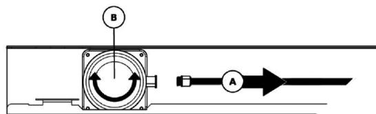
A. Najpierw odłącz kabel prowadzący do światła LED, które chcesz wymienić. Odłącz, luzując blokadę, wywierając niewielki nacisk podczas ciągnięcia.
