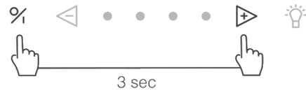
Para desactivar la función InTouch, pulse las teclas **1** y **2** simultáneamente durante 3 segundos; el segundo y cuarto indicador LED parpadearán 3 veces a modo de confirmación (el electrodoméstico debe estar apagado).
